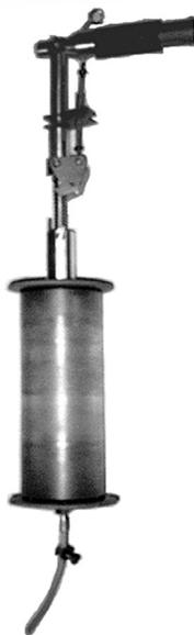
*Рис. 3. Батометр Рутнера*
